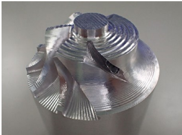
溝加工時に折損
